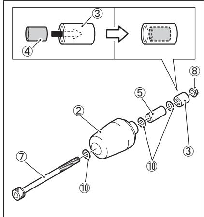
6. Den Hinterachsschieber (L) ② am Motorrad montieren.
