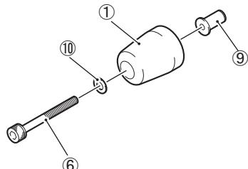
2. Instale el deslizador del eje trasero (Der.) ① en la motocicleta.
